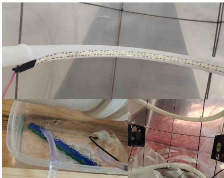
3.10 - сурет – Желдеткіштердің, LED шамының және су сорғының қосылуы
