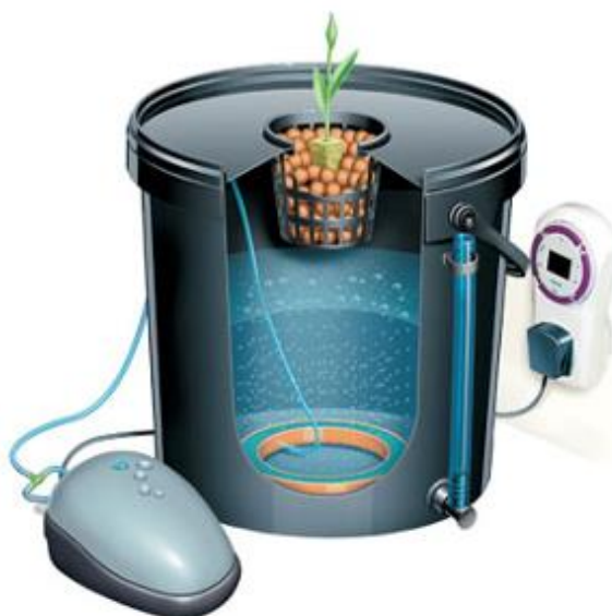
2.1 - сурет – Терең суда өсірілетін дақыл жүйесі(DWC)
